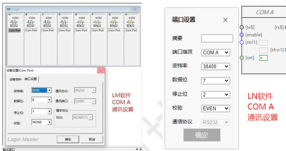
LM/LN 工程中的 COM A 通讯协议配置不同的设置内容，当工程合并运行后 COM A 将按照 LM 软件中设置的“波特率：9600、数据位：8、停止位：1 校验位：NONE”执行。当 LM/LN 工程中模块的[enable]信号冲突时，[enable]信号均置为高。
