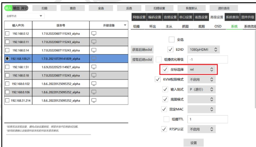
输入节点-高级设置-系统-坐标选择-rel, 重启生效。(rel-相对模式、abs-绝对模式)
