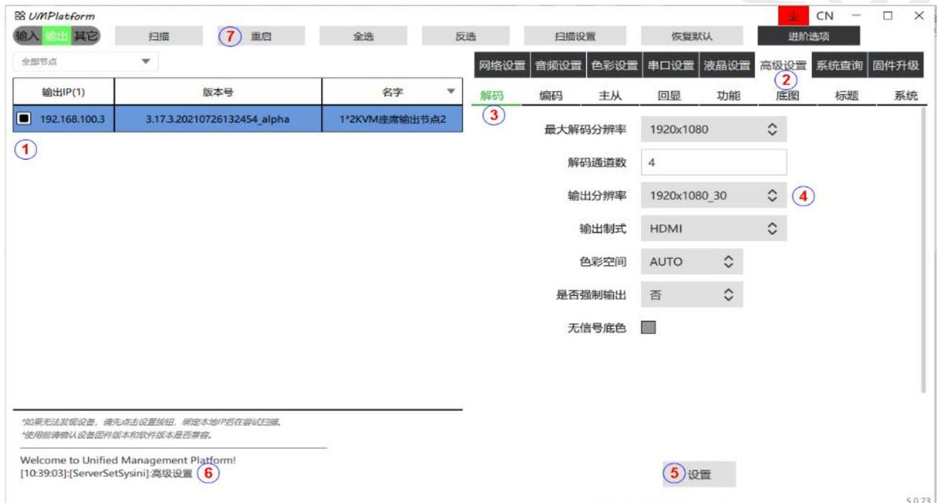
选择输出分辨率或者自定义分辨率，不能超过 1080P@60，解码通道数设置为 4。设置步骤如下图所示。视频墙绑定节点详见第五章。
