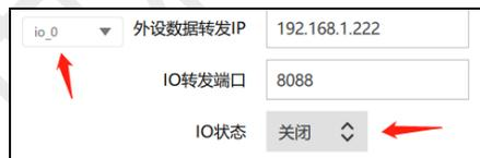
第二步：节点拨码为输出节点，使用 UMPlatform 设置红外学习接收指令的电脑的 IP 和端口，网络助手 NetAssist.exe 的确认本地 IP 和端口和 UMPlatform 设置一致。同时关闭 IO0 和把 IO1 设置为发送并且发送 IO\_1=1，重启设备。
