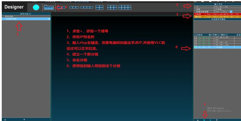
如下图步骤进行增加 rtsp 流接入，接入前，建议使用第三方 VLC 软件进行测试视频流是否正常，在进行配置。是否兼容，以测试为准。大部分海康、大华、华为产品可以对接。系统接入最大为 128 路，更高配置需求请咨询供应商。
