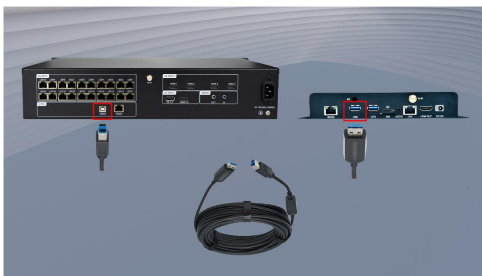
图 3-2 H4K 与 VP 处理器通过 USB 线连接
